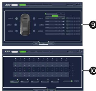
После запуска приложения вы увидите главный экран, в левом верхнем углу экрана, находится кнопка сопряжения с преобразователем, серый цвет кнопки означает что преобразователь отключен, зеленый цвет означает успешное соединение. Нажмите на кнопку
